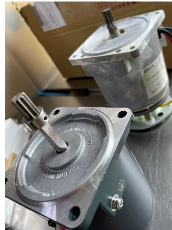
リミットスイッチ交換：東淀川浄水場 排泥促進弁 2 - 8 モーター交換：東淀川浄水場 (手前：新設 奥：既設 (故障))
